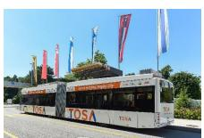
Le batterie del bus TOSA vengono ricaricate parzialmente per 20 secondi presso le cosiddette stazioni di ricarica «flash» lungo il percorso nonché completamente al capolinea, durante il tempo di attesa di 4-5 minuti. Fonte foto: Etat de Genève, Demir Sönmez
